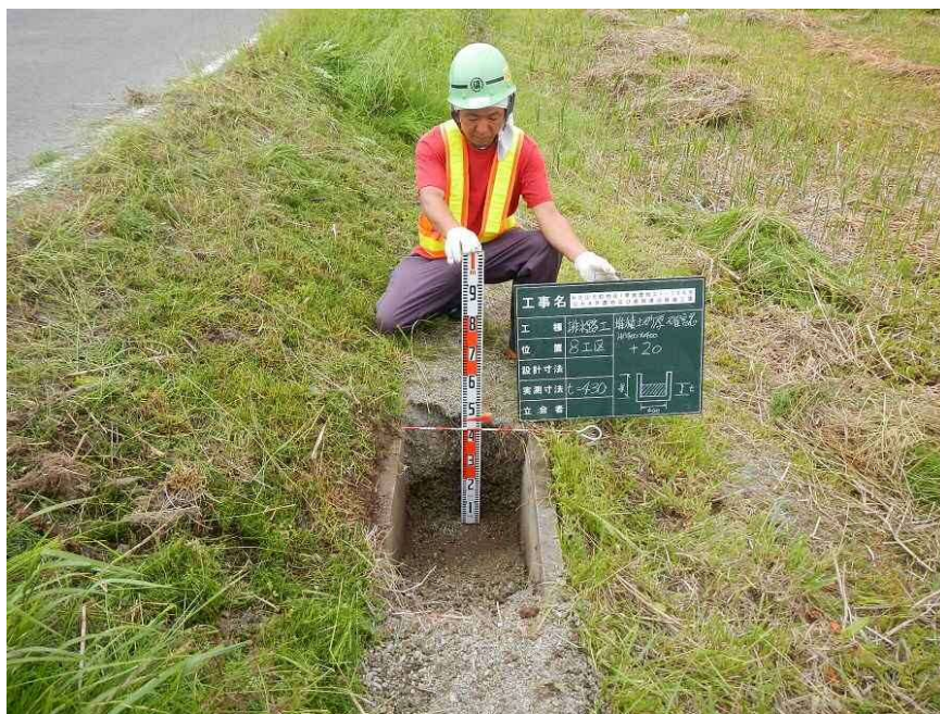
水路の堆積土砂調査
