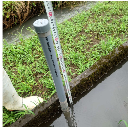
現地での水位計データ観測状況
